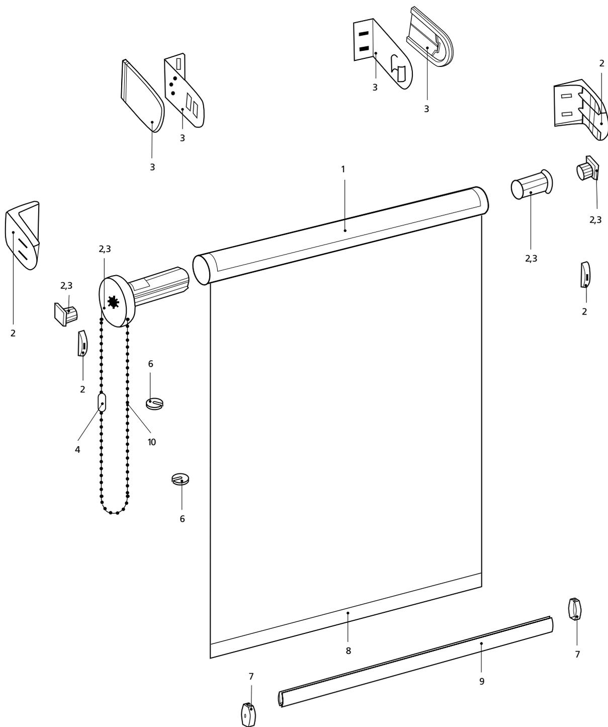
**Комплектация для рулонных штор MGS-ЗЕБРА**
