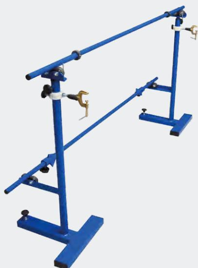
Напольное размоточное устройство LS-1 предназначено для размотки рулонной ткани с последующей ее резкой на отрезной линейке. Рулон ткани устанавливается на ось, которая в свою очередь держится на двух опорах. Одновременно на устройстве может находиться 2 рулона.
