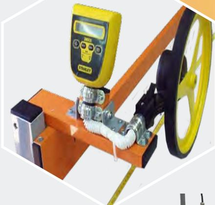
Счетчик ткани позволяет измерять расход ткани, особенно в случае использования рулонного стола для изготовления отрезков ткани.
