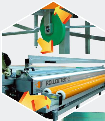
Система центрирования предназначена для корректировки положения рулона ткани на размоточном устройстве стола. При вращении специального колеса влево/вправо валы размоточного устройства двигаются вперед/назад вдоль линии реза. Автоматическая система центрирования имеет набор датчиков и приводов, которые выравнивают положение рулона ткани без участия оператора.
